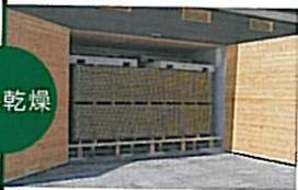
約7日～20日間乾燥釜に格納し、含水率20%以下に落とします
